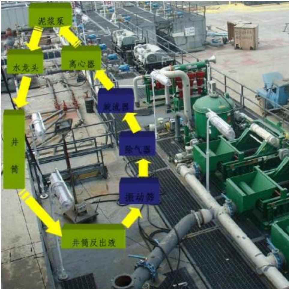
图 4-1 钻井泥浆循环利用流程示意图
