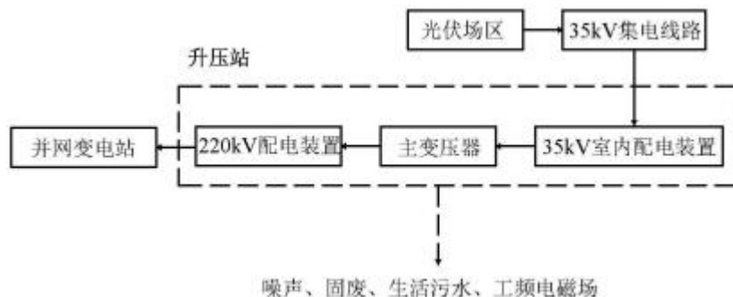
图 2.8-3 运营期工艺流程及产污节点
